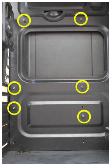
Рисунок 1 – Стойки, установленные на раме корпуса ПЭВМ
