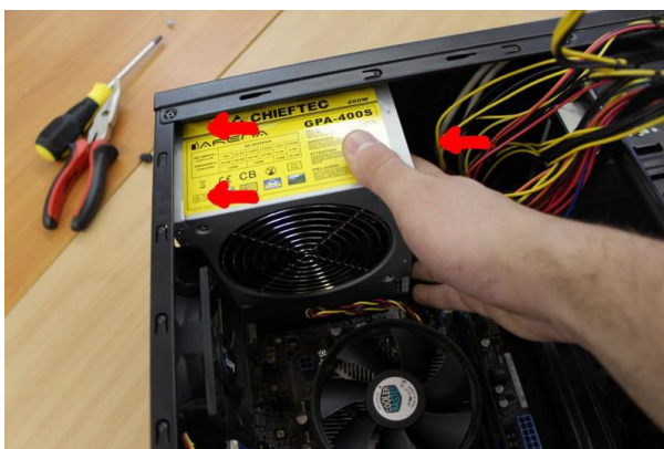
Рисунок 6 – Установка блока питания
