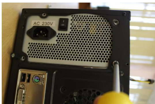
Рисунок 7 – Фиксация блока питания
